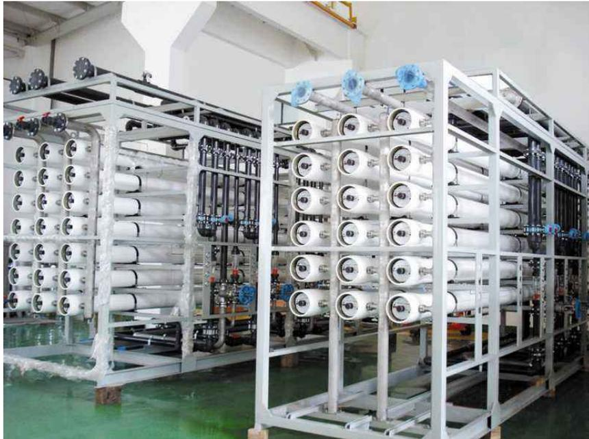
工业纯净水设备日常怎样维护保养在工业生产中需要用到工业纯水设备来保证用水的平安，而工业纯水设备的正常运行就需要我们平时维护与保养，工业纯水设备日常维护保养如下：反渗透的总进水量(即产水和浓水之和)由RO进水调节阀来控制，如果反渗透进水量没有变化，则不要乱动RO进水调节阀，严禁全开或全闭;RO浓排调节阀用来调整系统回收率，如回收率没有变化，则不要乱动浓排调节阀，禁止全开或全闭。当反渗透装置发生高低压报警时，先检查保安过滤器至高压泵这间的手动阀开度是否太小，然后检查RO进水调节阀及浓排阀是否正常，再按高低压报警复位按钮，重新启动设备。严格控制进水水质，保证装置在符合进水指标要求的水质条件下进行。存水的周期不要大于24个小时，罐体较好采用的是不锈钢材质，抗腐蚀，耐酸碱。内壁较好不要有死眼。西藏\*\*纯水设备耗材
