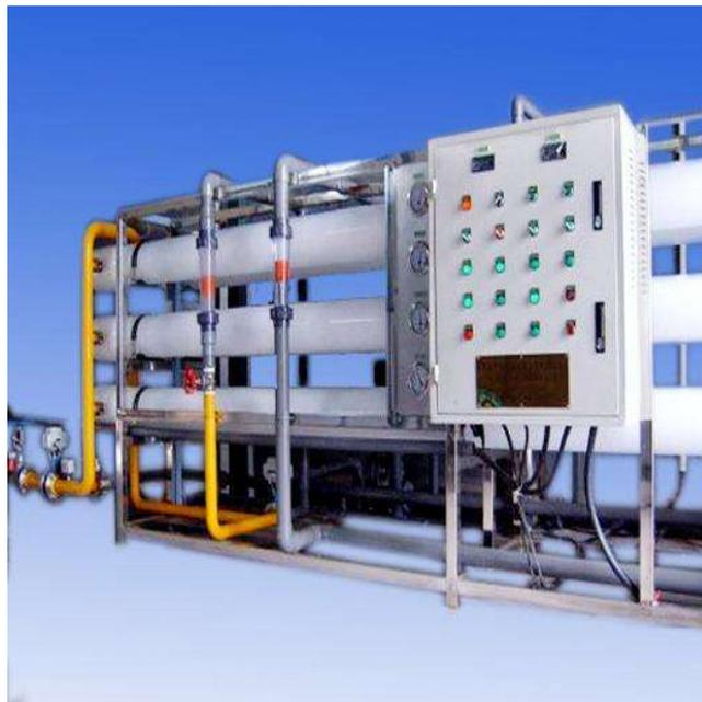
反渗透纯水设备日常运行维护注意事项1、当反渗透装置进出口压差超标时，表明膜表面已被污染或给水流量超过设计值。如果通过流量调节无法解决压差问题，则应清洁膜面。2、给水流量过大会提前使膜组件劣化，因此给水流量不得超过设计标准值。此外，浓水流量应尽可能不小于设计标准值。如果浓水流量过小，反渗透装置的压力容器内会出现流量不均，浓度过高会在膜组件上析出污垢。3、即使反渗透装置的高压泵中断非常短时间，装置也可能出现故障。4、醋酸纤维素膜的水解容易恶化反渗透装置的性能。因此，需要严格控制水的pH值，给水的pH值需要保持在5-6，复合膜可以在给水pH3-pH11范围内运行。5、当反渗透装置停止运行时，用低压给水代替反渗透装置中的水。这是为了防止在停运时二氧化硅的析出（在冬季时水温下降之故）。6、当注
